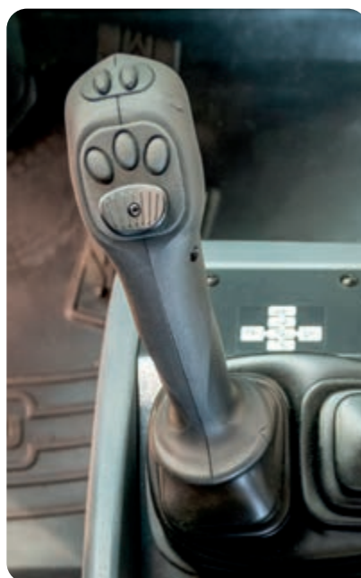
Leva multifunzione PPC con controllo elettronico opzionale per la terza e la quarta via (EPC)
