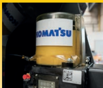
Il sistema di lubrificazione automatica montato in fabbrica riduce al minimo gli interventi giornalieri (optional)
