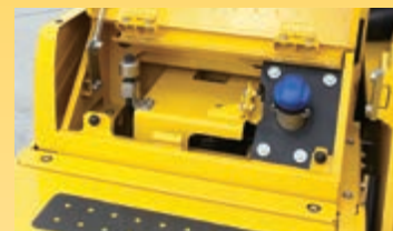
Per semplificare l'accesso, il serbatoio AdBlue® è installato vicino alla scala anteriore.
