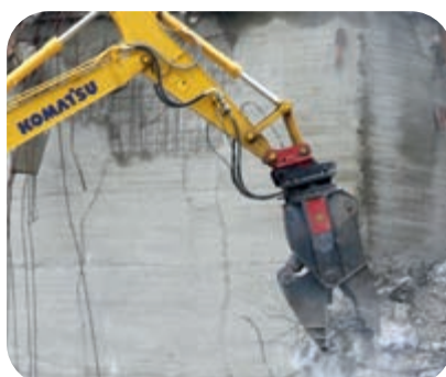
Due linee idrauliche opzionali per montare una serie di accessori
