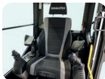
Sedile premium opzionale con ammortizzazione ottimale, regolazione automatica a seconda del peso dell'operatore, supporto lombare, sistema di condizionamento, disponibile con braccioli opzionali multiposizione e leve di comando ergonomiche
