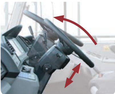
Disposizione del volante nella posizione più comoda
