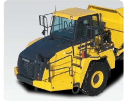
Sistema ROPS/FOPS integrato conforme alle norme ISO 3471 e SAE J1040-1988c
