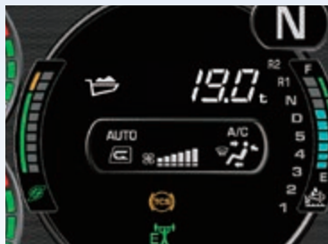
La bilancia di pesatura del carico utile visualizza il peso a pieno carico
