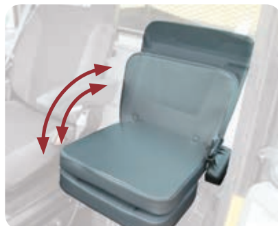
Il sedile passeggero a misura intera è dotato di cuscino pieghevole e poggiatesta per facilitare l'ingresso in cabina e l'accesso al filtro del condizionatore e al vano portaoggetti.
