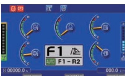
Modalità cambio automatico per ottimizzare ulteriormente il consumo di carburante
