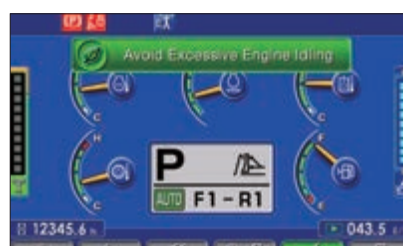
Indicatore Eco, guida Eco e indicatore livello carburante
