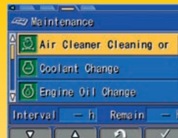
Monitor multifunzione aggiornato per fornire all'operatore informazioni sullo stato di manutenzione
